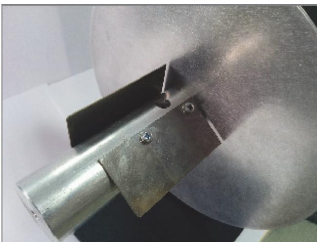
2. Посадка картонной втулки на шпиндель с пластинаами-адаптерами должна быть скользящая и не требующая чрезмерных усилий при надевании или снимании. Пластины имеют увеличенные крепежные отверстия, что позволяет выполнить регулировку посадочного размера в небольших пределах.
