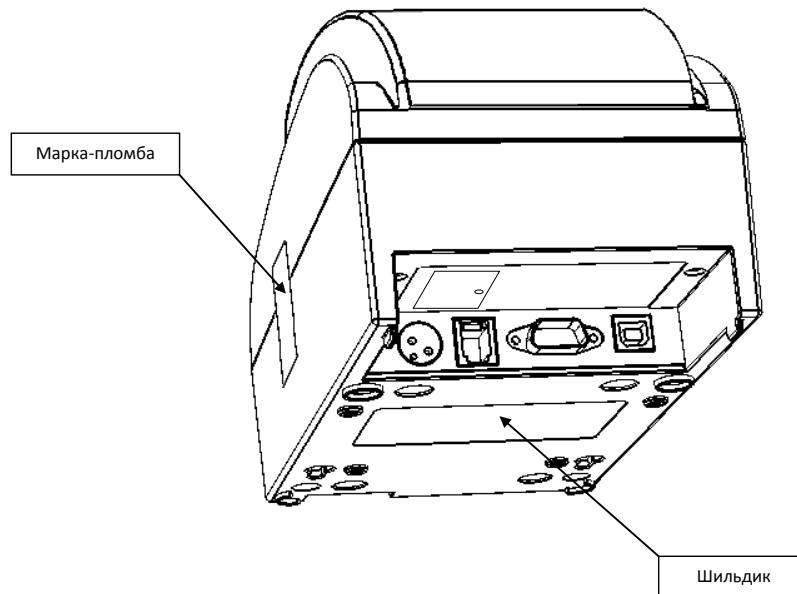
Один элемент марки-пломбы наклеивается на кожух, закрывающий блок управления и устройства печати кассовых чеков так, чтобы было невозможно получить доступ к внутренней части ККТ без разрушения марки-пломбы. Шильдик наклеивается на дно корпуса ККТ.
