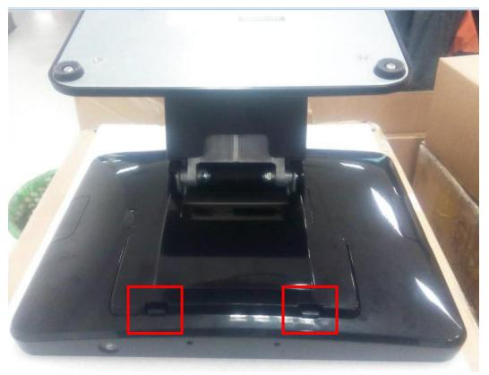
2. 拆下后盖上面的3个小塑料盖子 Disassembly 3 covers
